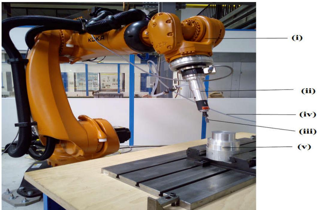
**Figure 4. 3.** Étude de Cas 2 : Cellule robotisée d'usinage de parachèvement de pièces cylindriques
