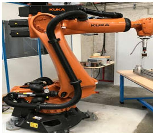
*Figure 1. 1. Robot sériel anthropomorphe, Robot KUKA KR 120, (LGP, 2023)*
