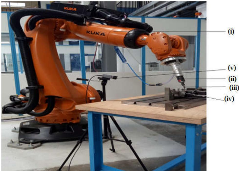
**Figure 4. 2.** Étude de Cas 1 : Cellule robotisée d'usinage de parachèvement de pièces parallélépipédiques
