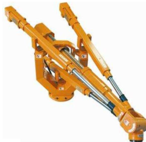
*Figure 1. 5. Robot parallèle intégrant un mécanisme sériel, Robot Tricept T606, (Moussavi, 2016)*
