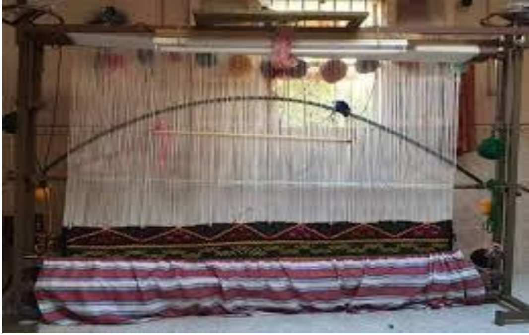
صورة توضح آلة السدة التي تستعمل في النسيج
