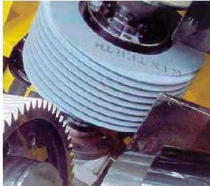
**Figure A.11** : Rectification des dentures.
