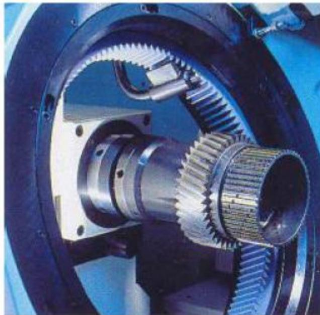
**Figure A.12** : Rodage des dentures.
