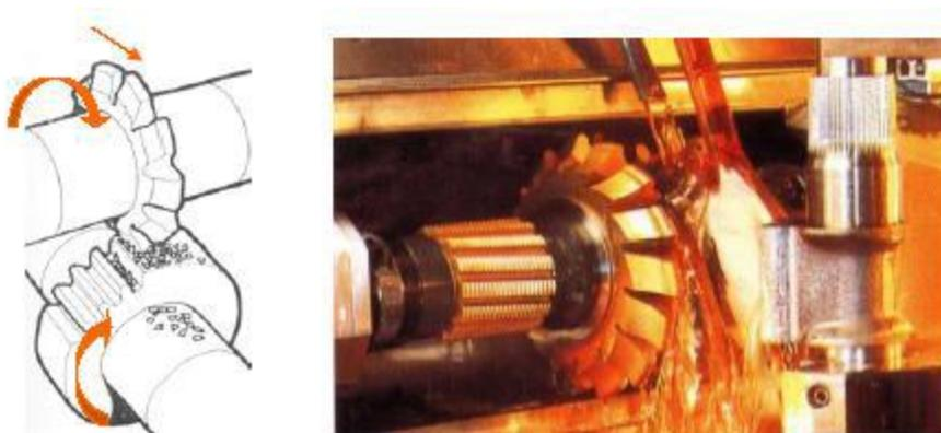
**Figure A.5** : Taillage à la fraise disque
