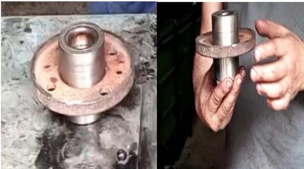
**Fig. IV.33 :** le raccordement des deux roulements avec le disque.
