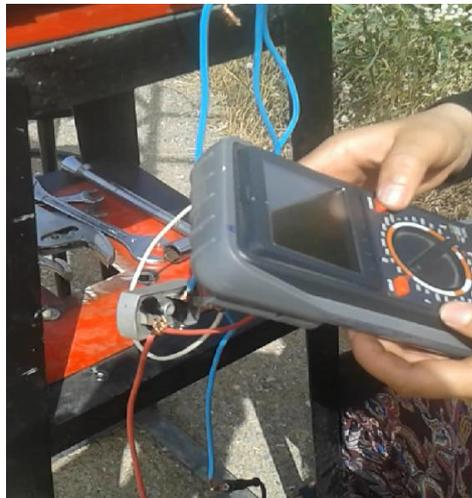
**Fig. IV.44** : mesure de la tension par le multimètre.
