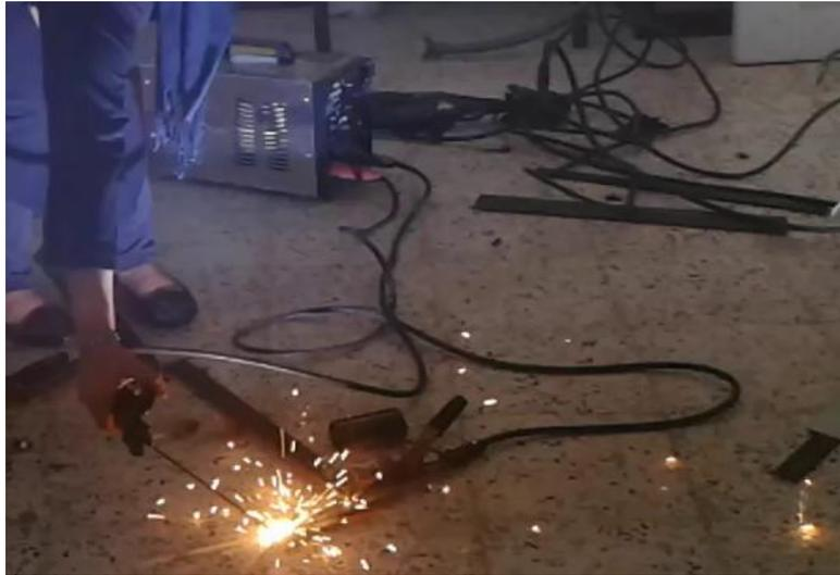
**Fig. IV.20** : La soudure de premier bras avec le tube.
