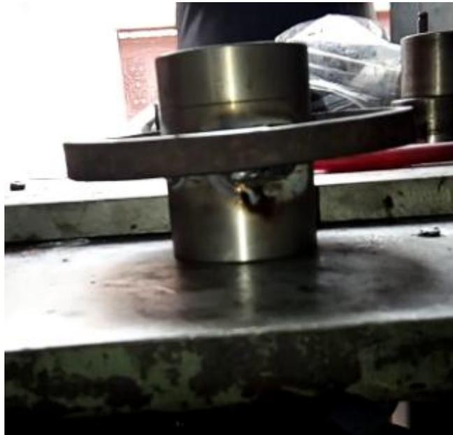
**Fig. IV.35 :** résultat final de la soudure du disque avec les roulements.
