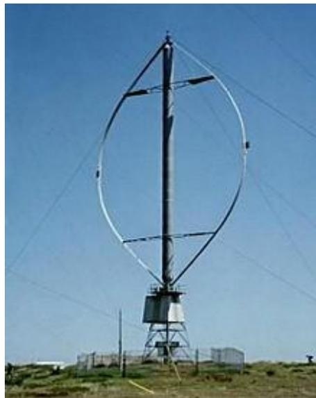
**Fig.I.3** : éolienne axe verticale DARRIEUS.
