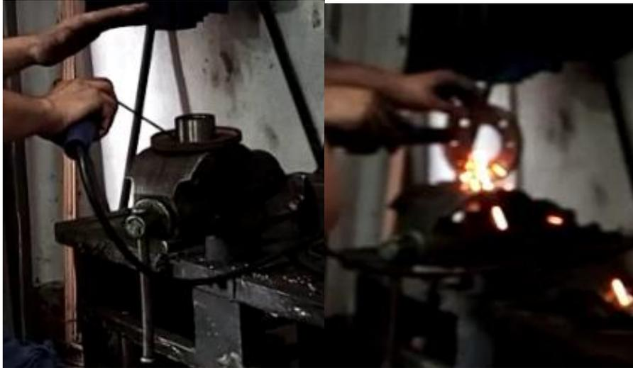
**Fig. .IV.34 :** la soudure des roulements avec le disque.
