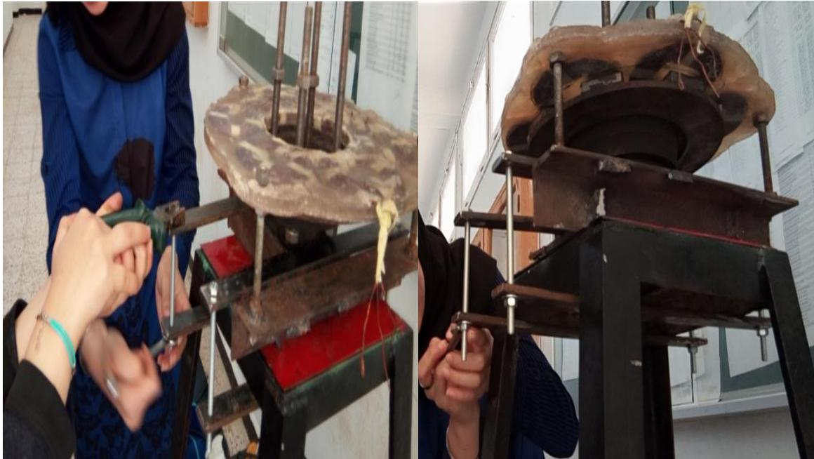
**Fig. IV.38 :** la fixation de la génératrice sur le socle.
