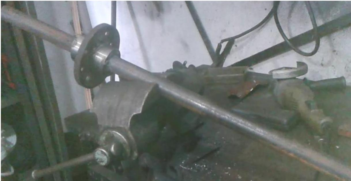
**Fig. IV.37** : fin de construction de l'arbre de rotation.
