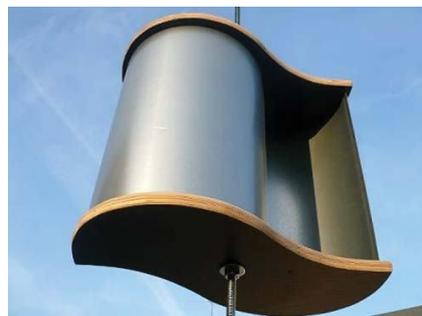
**Fig. I.14** : l'éolienne SAVONIUS.
