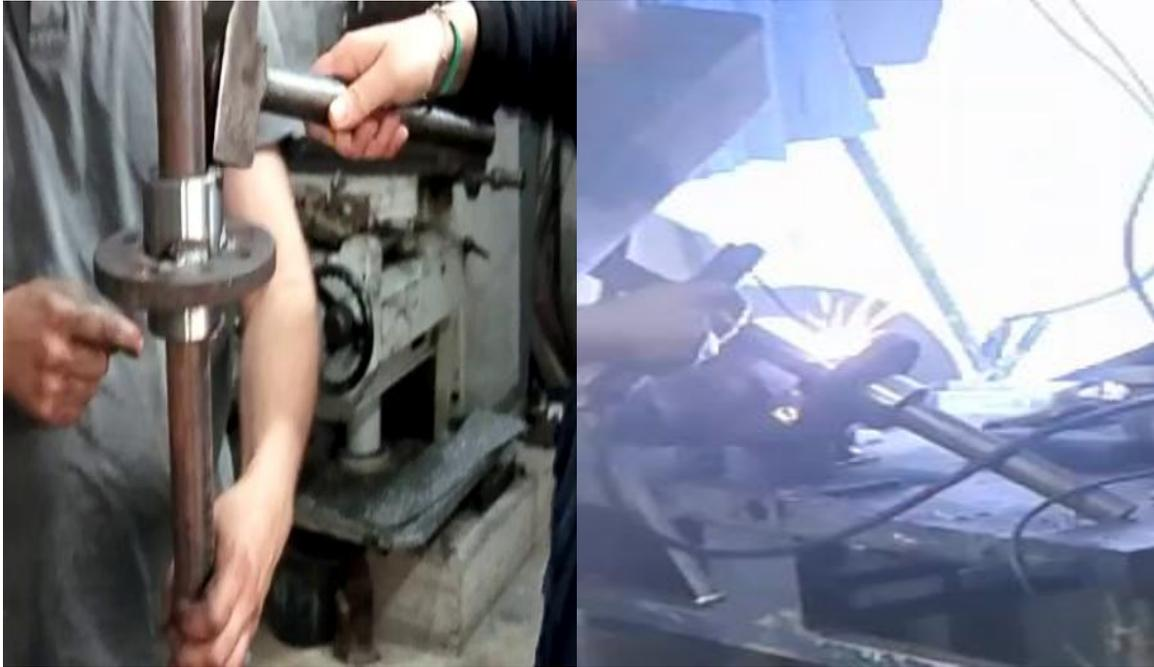
**Fig. IV.36** : compression et la soudure de cet ensemble sur l'arbre de rotation.
