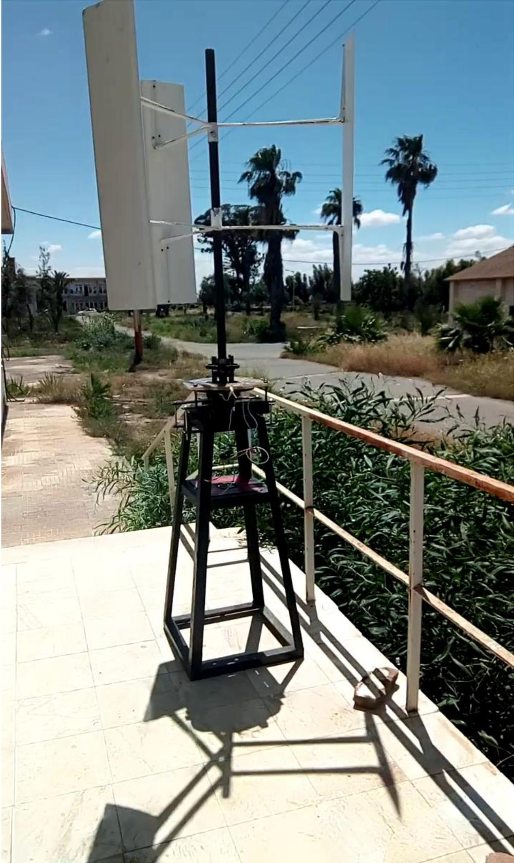
**Fig. IV.41 :** l'éolienne DARRIEUS-H.
