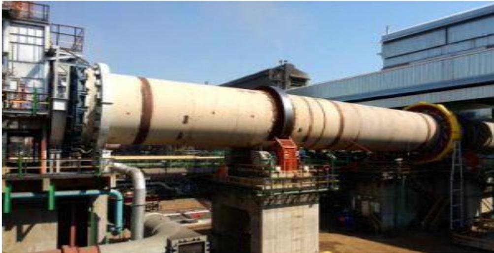
**Figure I.1 :** un four rotatif de la cimenterie
