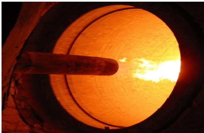
**Figure I.12:** Brûleur du four rotatif de cimenterie
