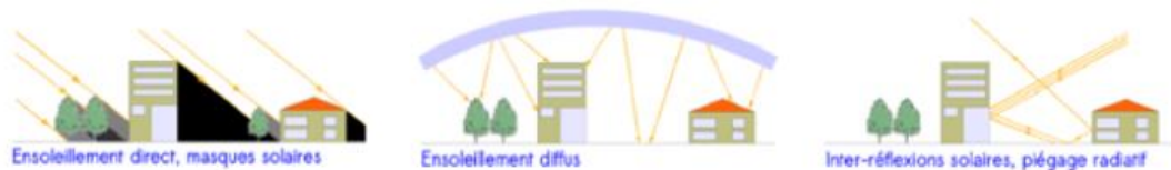
Figure II.13 : Illustration des rayonnements directs, diffus, et inter-réflexions solaires
