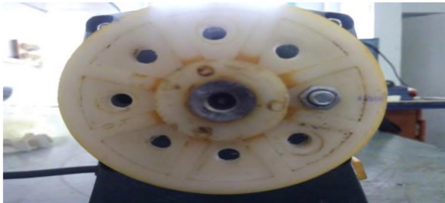
Fig. 4.8 : Création de balourd 1<sup>er</sup> essai plan 1
