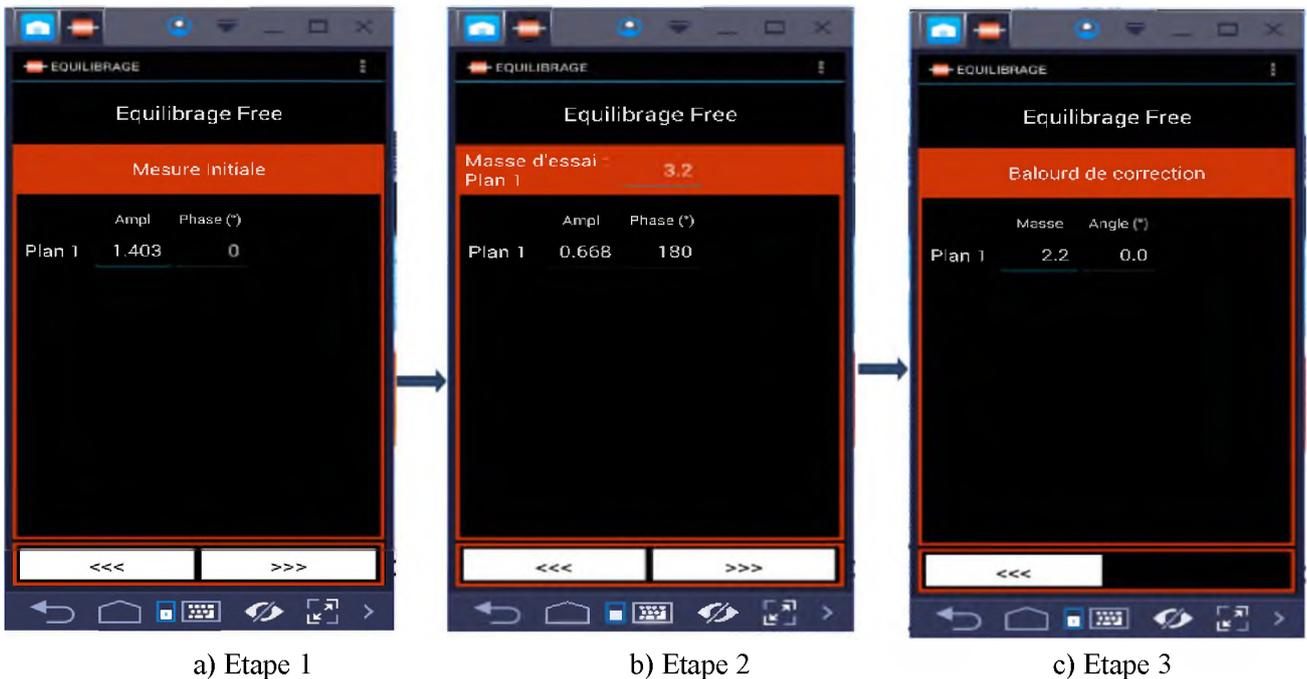
Fig. 4.11 : Correction du balourd à l'aide de « Vibra ToolBox »
