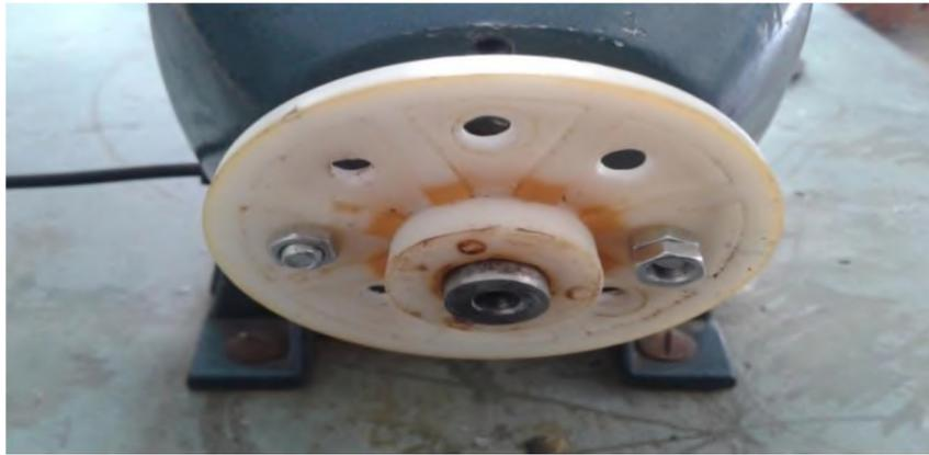
Fig. 4.10 : Masse de correction à 180° plan 1
