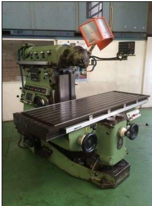
**Figure III.3** Fraiseuse universelle.
