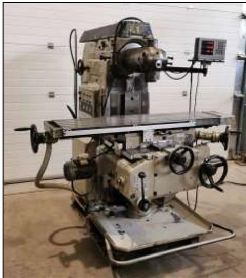
**Figure III.1** Fraiseuse horizontale.
