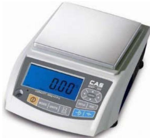
Figure II.6 : Balance numérique CAS MWP-600H.
