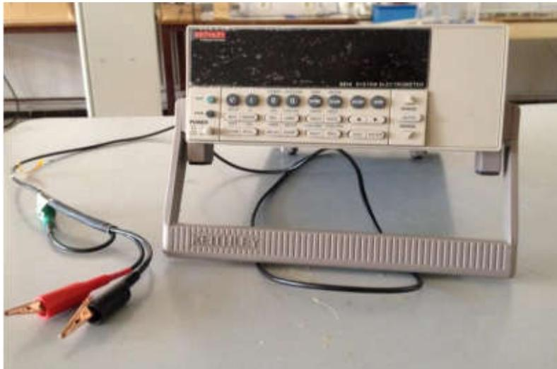
(**Figure II.4**) : Electromètre Keithley model 6514.
