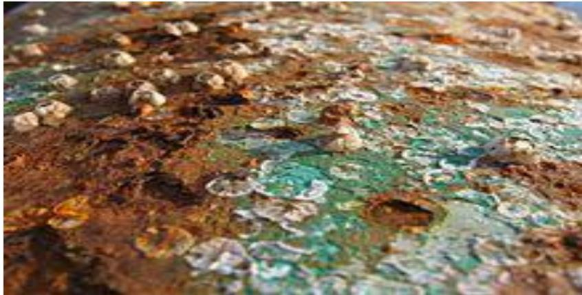
**Figure I.8.** Photo réel d'une surface extérieure d'un pipeline corrodé
