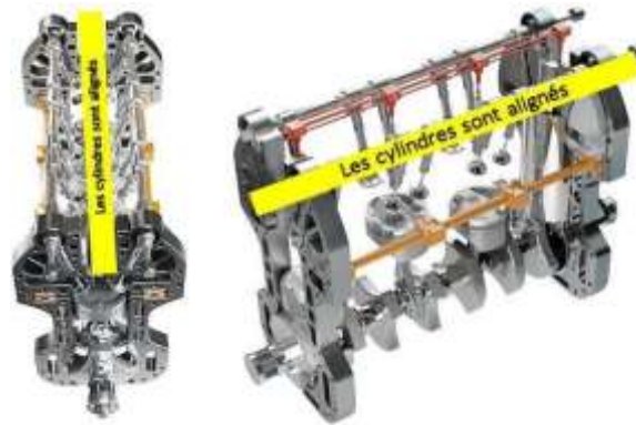
Figure I.11 Moteur en ligne.
