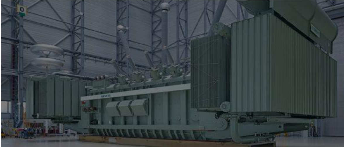
Figure II. 18 Transformateur de 420 KV à huile de végétale par siemens.
