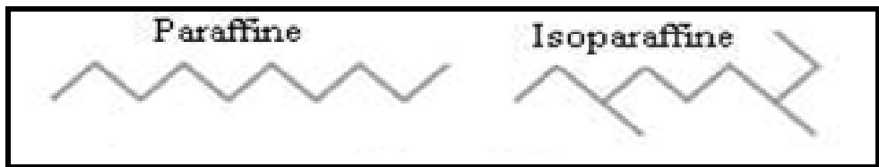
Figure II. 13 Structures chimique d'une huile paraffinique.
