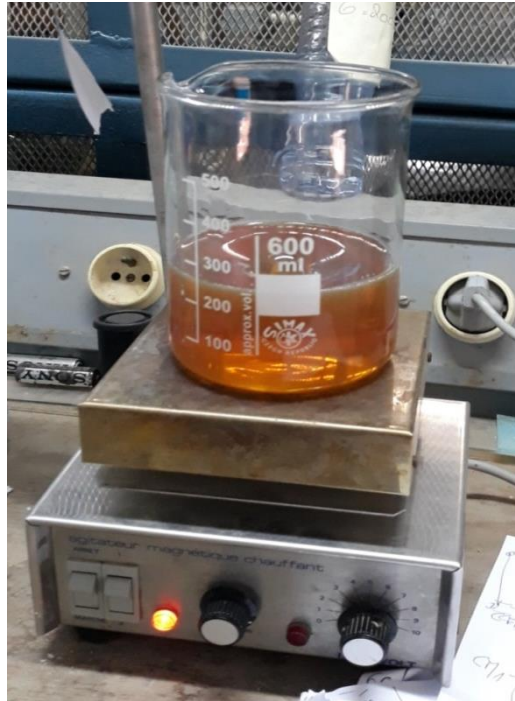
Figure III. 5 Mélange d'huiles à l'aide d'un agitateur à plaque chauffante.
