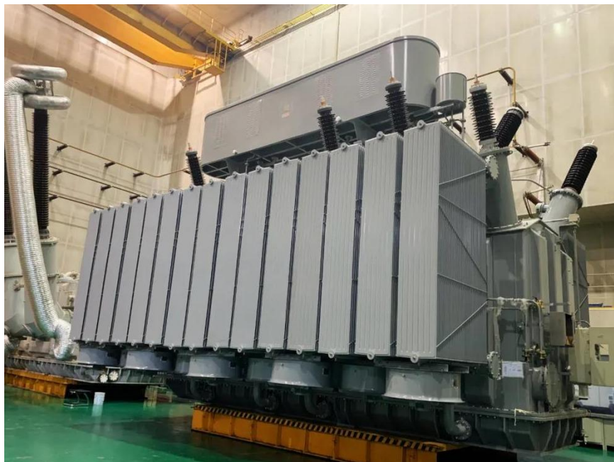
Figure II. 16 Transformateurs à huile végétale par china XD group.
