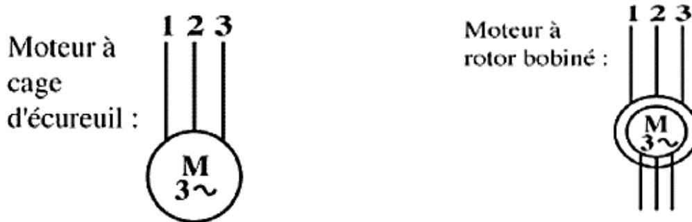
Figure 6 symboles d'une machine asynchrone
