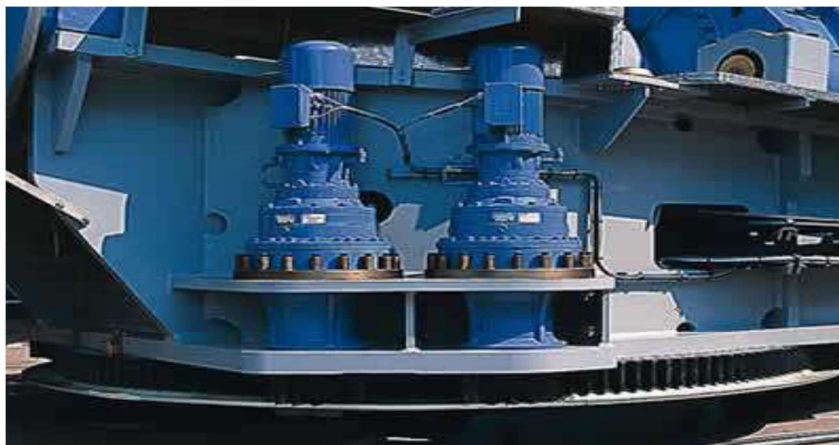
Figure II.11. Moteurs d'orientation d'une nacelle [48].
