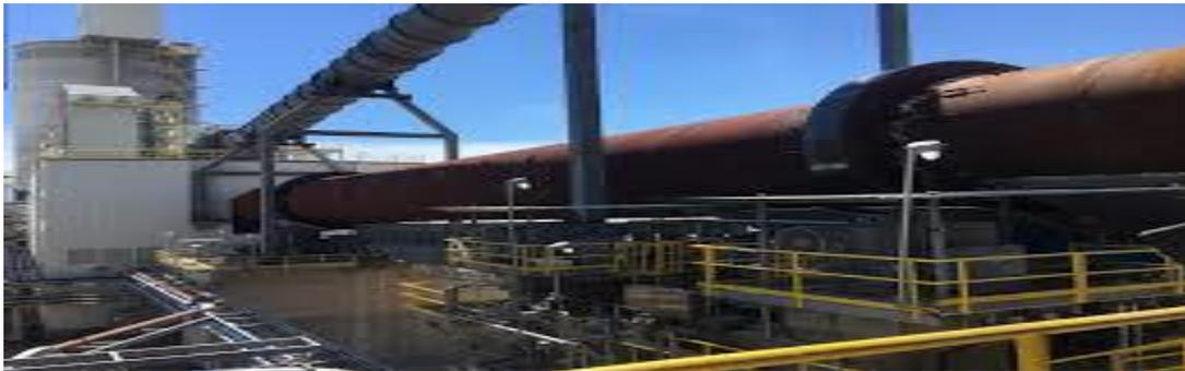
**Figure I.3 :** Four rotatif de voie sèche.
