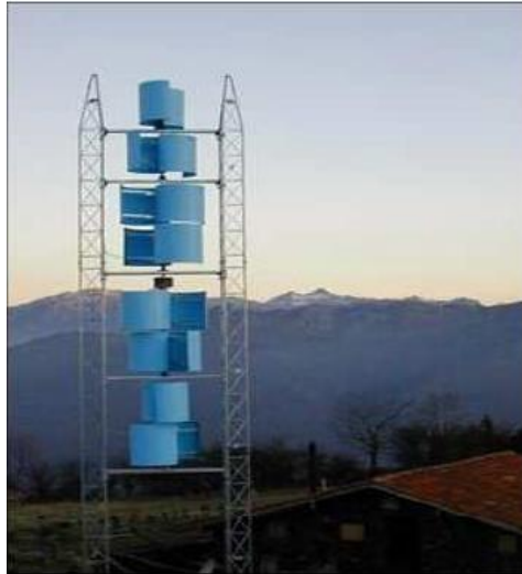
Figure I-9 Aérogénérateur à axe vertical (structure de Savonius)
