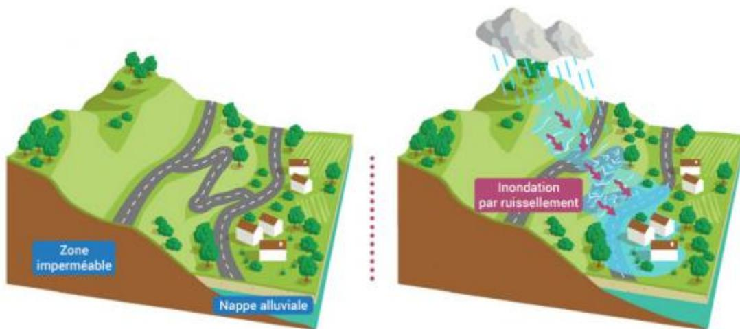
**Figure 6 : inondation par ruissellement**
