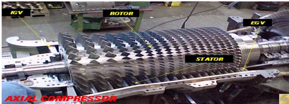
Figure IV.2: les différentes parties de compresseur axial [11]
