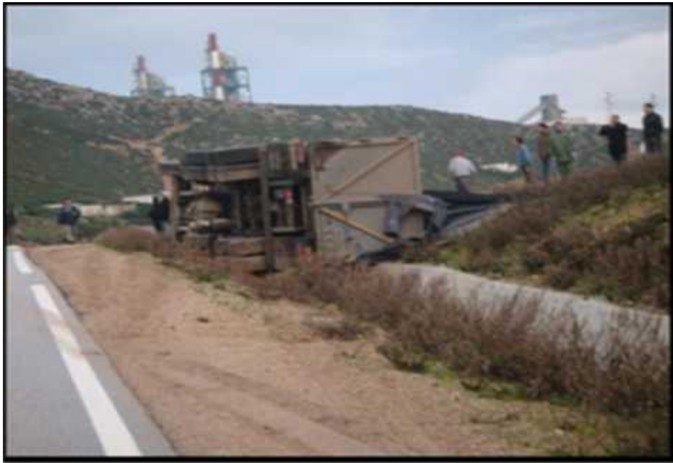
Figure II.6 : Renversement d'un camion transportant le coke et roulant avec une vitesse excessive
