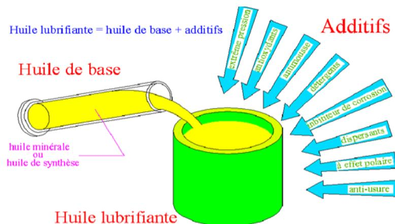
Fig. II.1 : Fabrication d'huile de lubrifiant à partir d'un mélange
