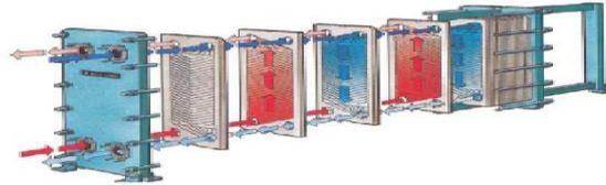
Fig. IV.3 : Echangeur à plaques
