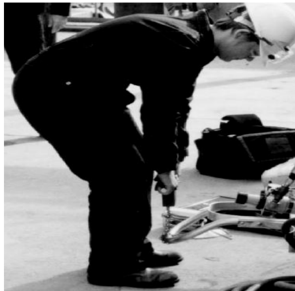
Figure III.10 : Utilisation d'une jauge de force pour mesurer une tâche de poussée / tirage
