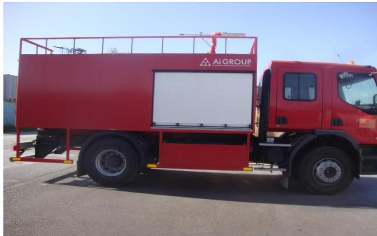
**Figure II.1** : Camion à poudre.**c) Véhicule incendie à eau**
