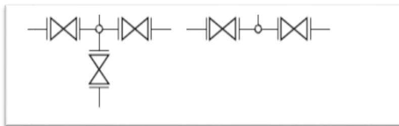
**Figure (II.1) :** Les vannes de sectionnement de réseau d'incendie
