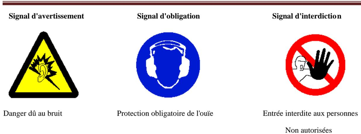
*Figure III.12 : Les types de signalisation.*
