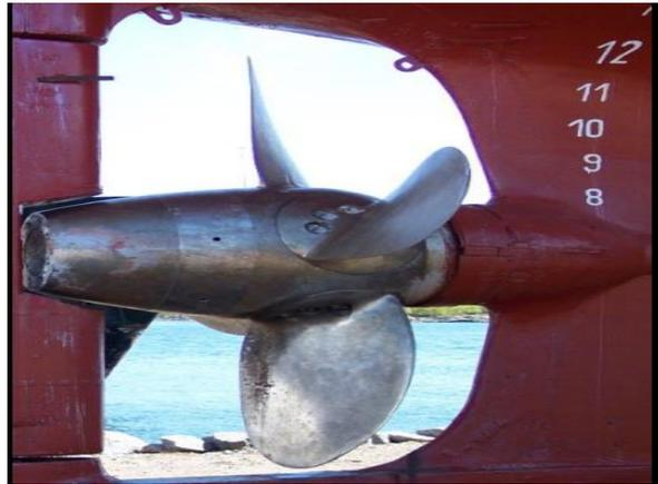
**Figure II.62 :** Hélices à pas variable.
