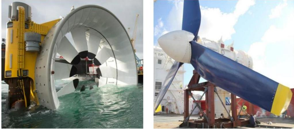
**Figure III.24 :** Pales et tuyère en composite de l'hydrolienne et Pales en composite de l'hydrolienne.
