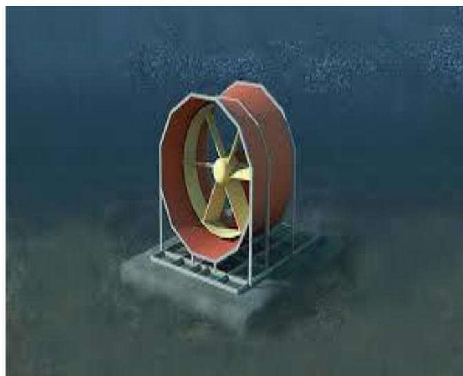
**Figure III.25 :** hydrolienne carénée. [71]
