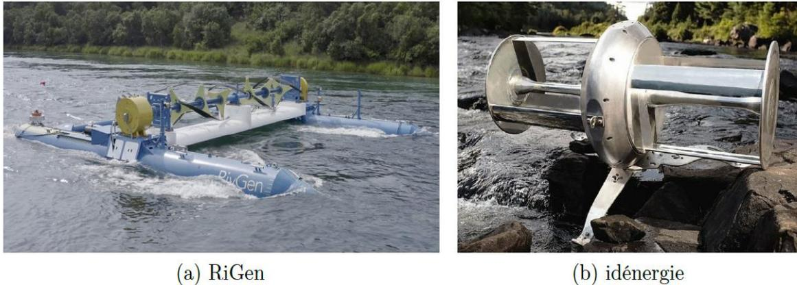
**Figure II.84 :** Exemples d'hydroliennes à axe transverse. (a) : turbine RiGen de ORCP 80kW, (b) : turbine de noa 0.5kW.
