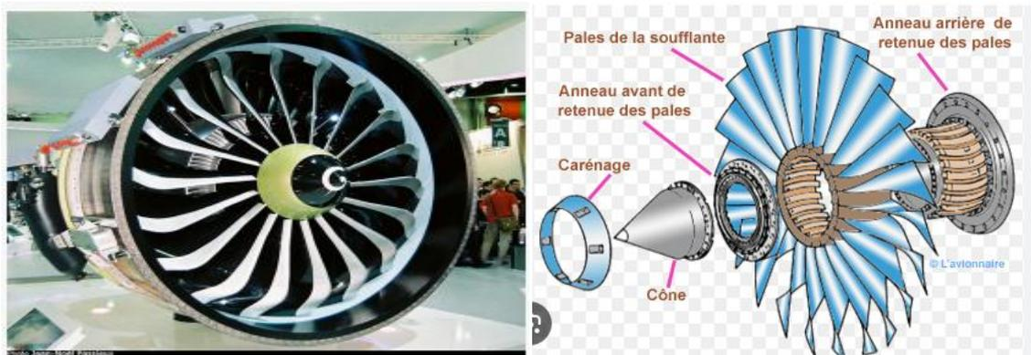
Figure II.90 : hélice ou soufflante.
