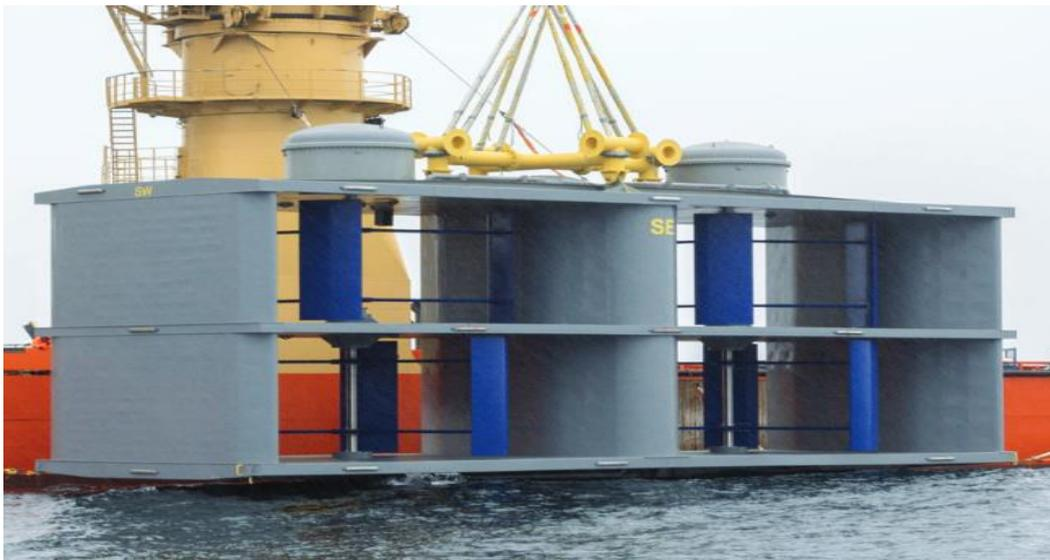
**Figure II.83 :** Exemples d'hydroliennes à axe vertical : turbine OceanQuest d'HydroQuest, 1MW (250kW par rotor).
