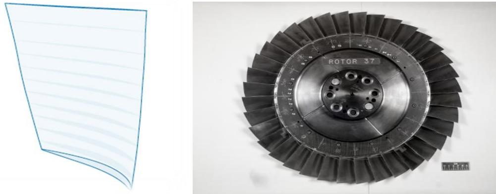
**Figure I.2 :** Aube du rotor 37.
