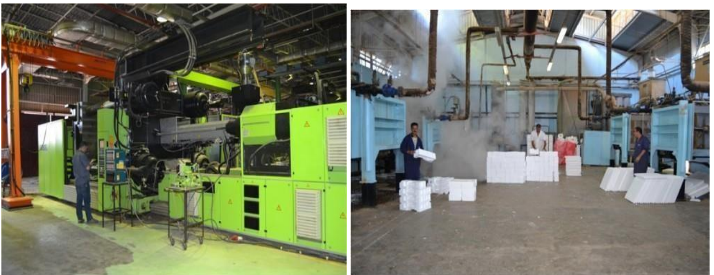
Figure 11: Machine d'injection plastique expansé (figure à gauche), Injection polystyrène (figure à droite).
