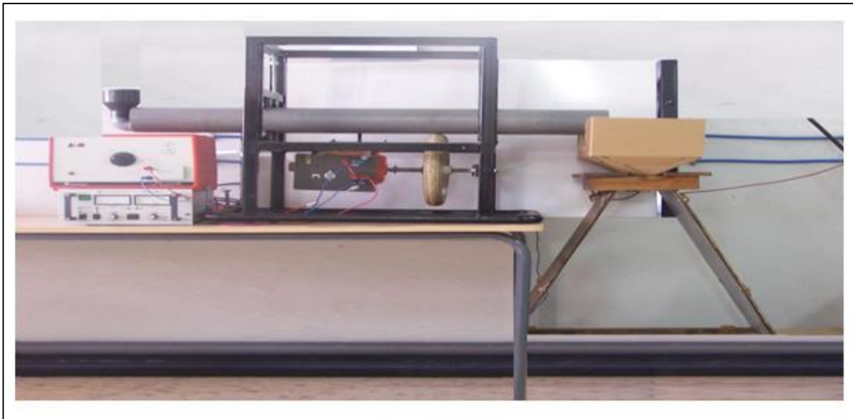
Figure II.11 : Photographie de dispositif de Séparation Triboélectrique à chute libre « Séparateur triboélectrique des matériaux plastiques » (Réalisé au laboratoire IRECOM de l'université Sidi Bel Abbas)
