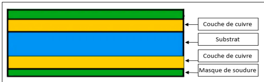
Figure I.13 : La structure du PCB double face
