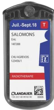
Figure 7 : Dosimètre passif
