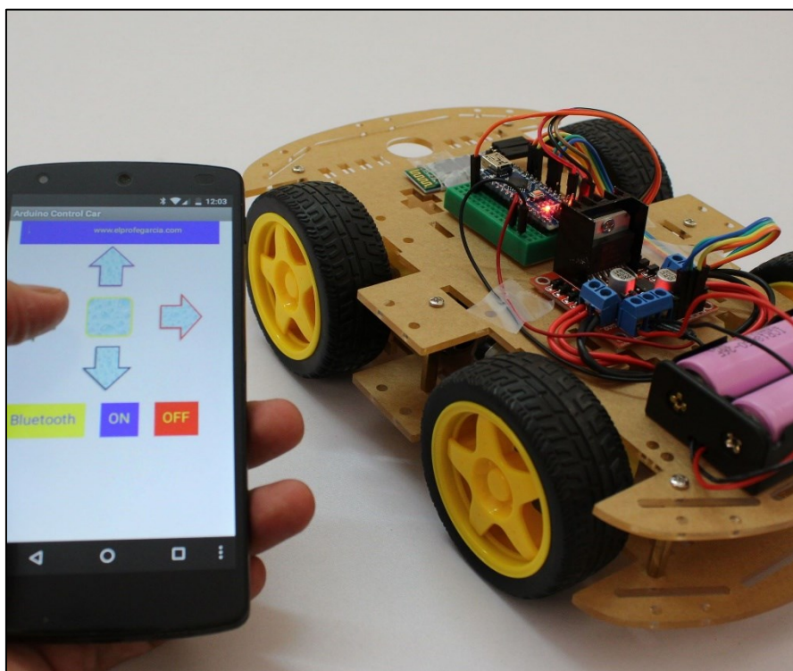
Figure IV.19: la Voiture pour la collection des données
