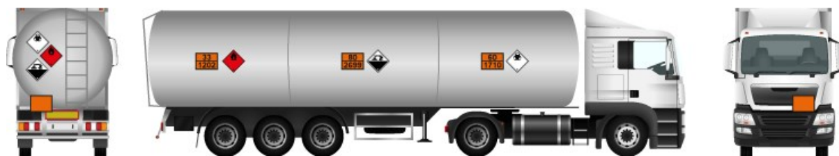
Figure I. 2:Un Camion-citerne avec étiquetages
