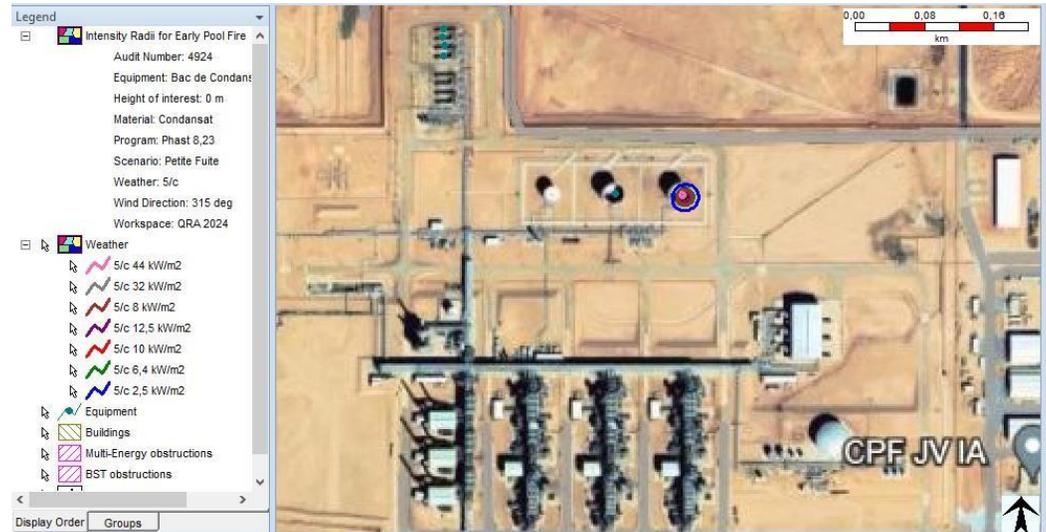
Figure 30 : Simulation du Early POOL FIRE du Bac de Condensat, Petite Fuite.
