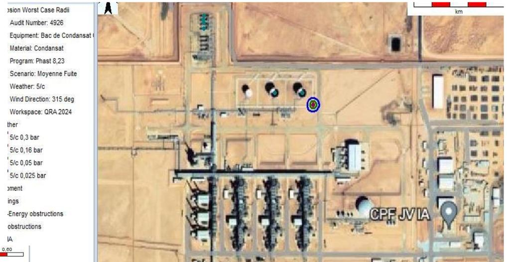
Figure 37 : Simulation d'EXPLOSION du Bac de Condensat, Moyenne Fuite
