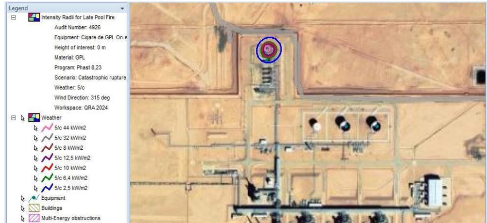
Figure 27 : Simulation du Late POOL FIRE de cigare de GPL, Catastrophe rupture.
