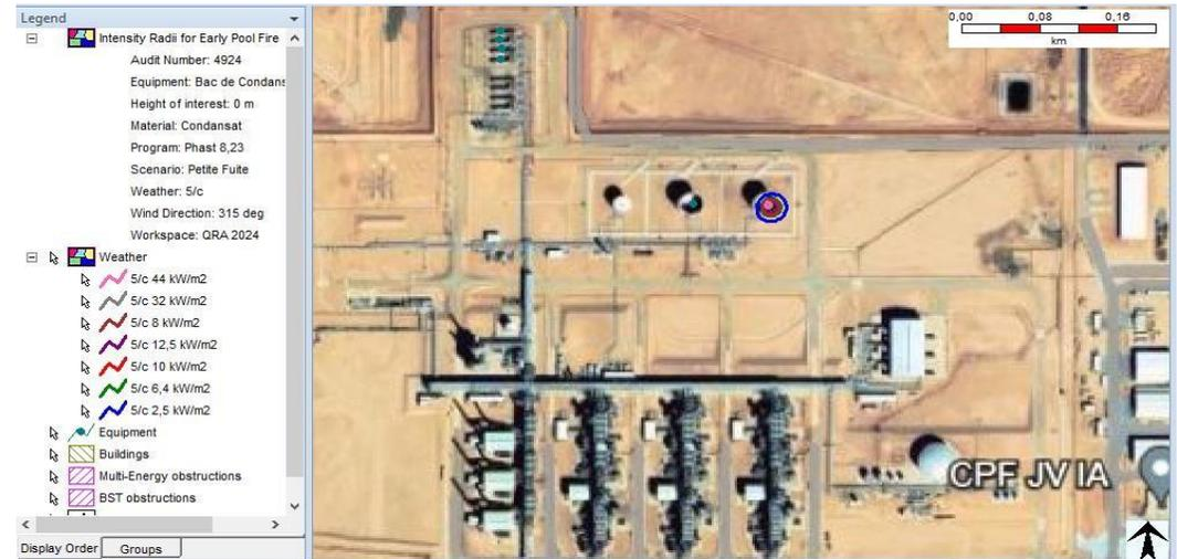
Figure 33 : Simulation du Late POOL FIRE du Bac de Condansat, Petit Fuites.
