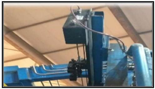
Figure 31 : : Le Capteur de régulation
