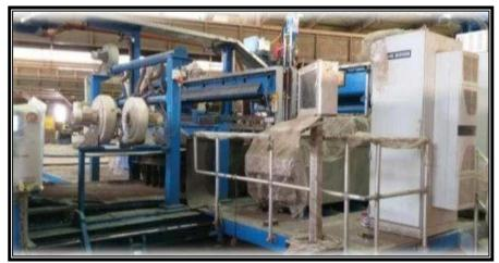
Figure 34 : Fraiseurs transversaux
