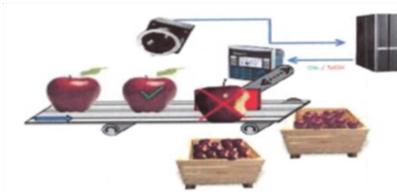
Figure II.6 : Détection de défaut
