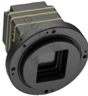
Figure I.5 : caméra thermique bolométrique non refroidie.
