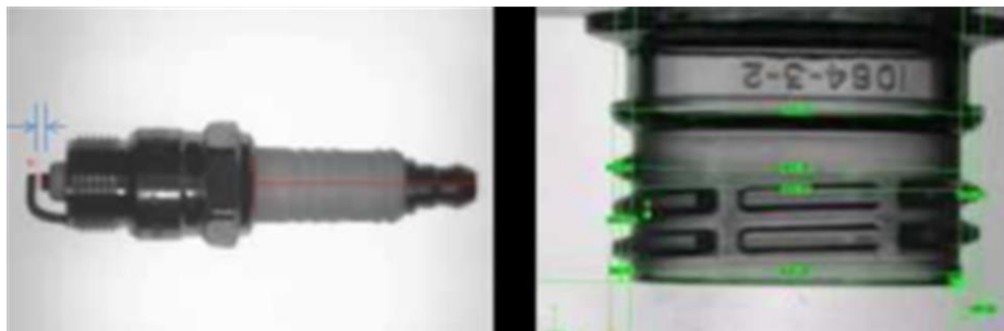
Figure II.5 : Les applications de mesure peuvent mesurer des pièces avec une tolérance allant jusqu'à 0,0254 mm
