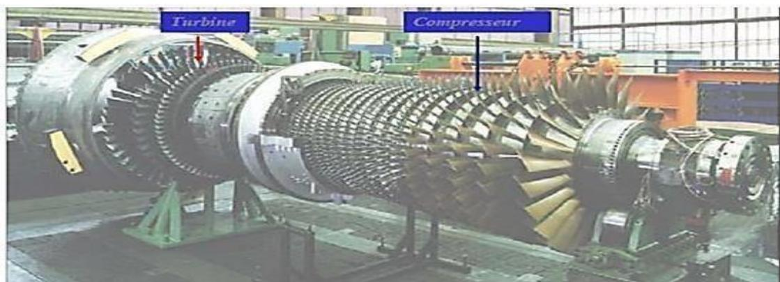
**Figure 2.15.** Le rotor du compresseur et de la turbine sur le même arbre
