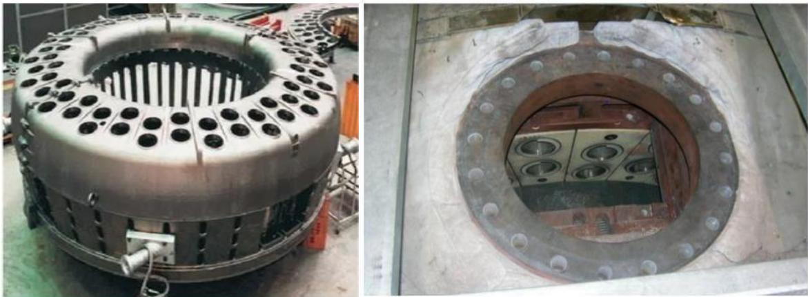
**Figure 2.13.** Chambre de combustion (Vue l'emplacement des brûleurs à travers un trou de visite.)
