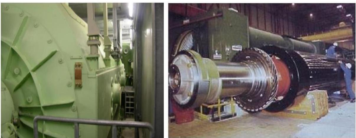
Figure 2.16. L'alternateur (vue d'extérieur).[28][29]
