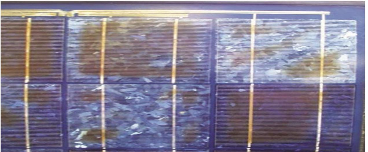
*Figure. III.4 : décoloration des panneaux solaires*
