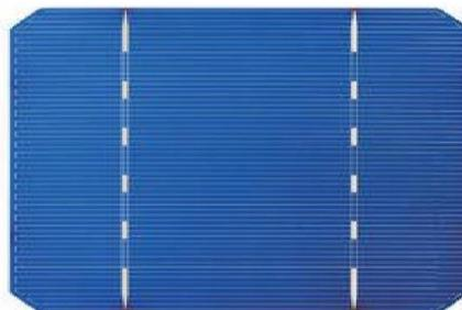
**Figure II.8** : Exemple cellule monocristallin
