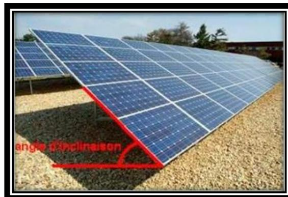
Figure IV.4 : L'angle d'inclinaison [28].
