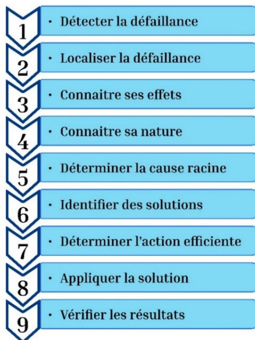
Figure III.9. La démarche de diagnostic de panne[1].
