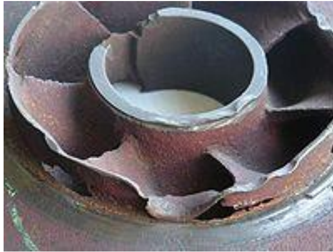
Figure II.13. Pompe centrifuge détruite par la cavitation [22].
