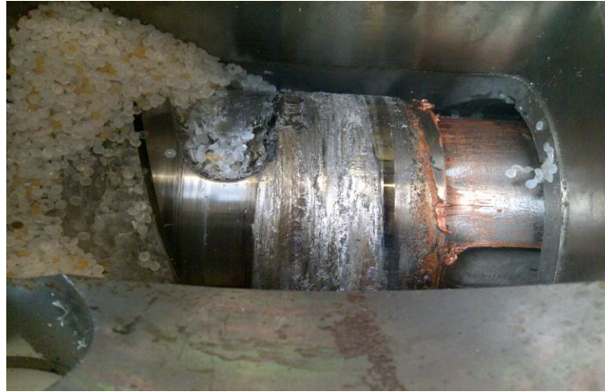
Figure II.11. Grippage d'un talon de vis d'extrusion [22].
