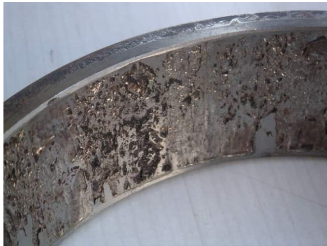
Figure II.10. Ecaillage sévère sur une bague de roulement[22].
