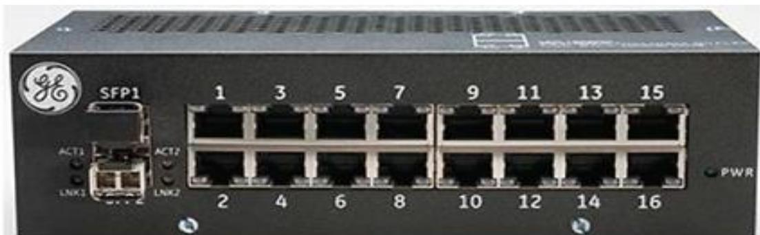
Figure 28 : Commutateur IONet.
