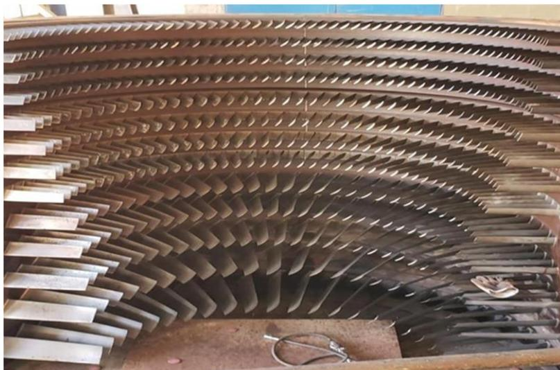
Figure 6 : Stator compresseur
