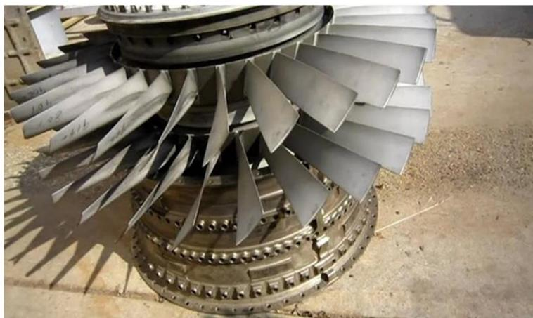
**Figure 5 : Rotor du compresseur**
