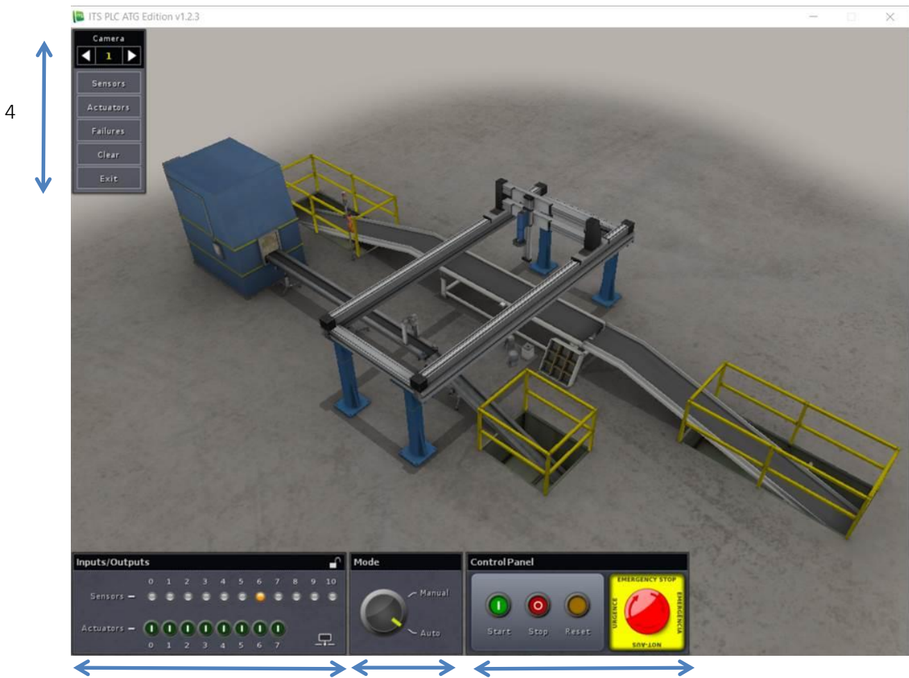
Figure III.4 : 1 Panneau Pratique (1- panneau des E/S. 2- panneau choix du mode. 3- 2 panneau utilitaire. 4- 3 panneau de commande)
