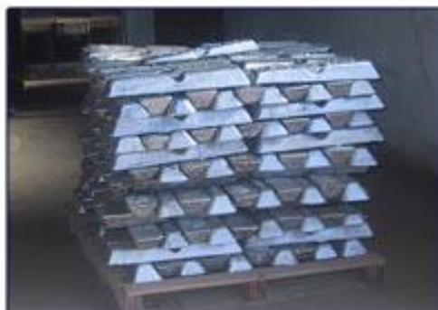
**Figure IV.4 :** *Lingots de plomb, aluminium, laiton*
