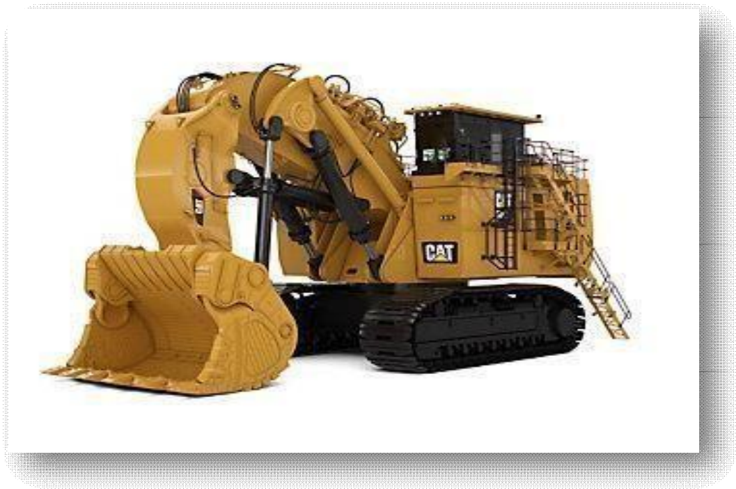
Fig. 8- La pelle mécanique en butte
