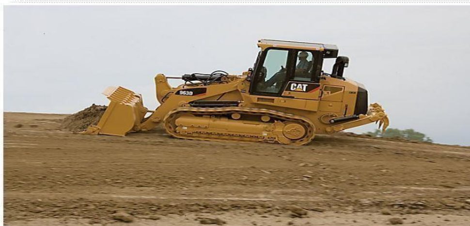
Fig. 6- Chargeuse sur chenil
