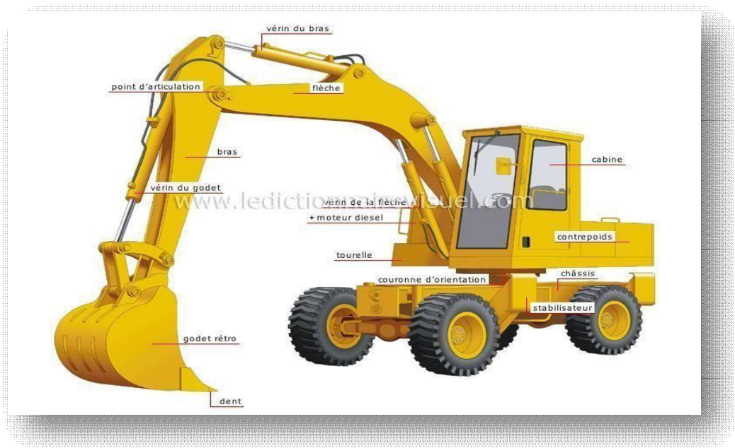
Fig. 7- La pelle équipée en rétro
