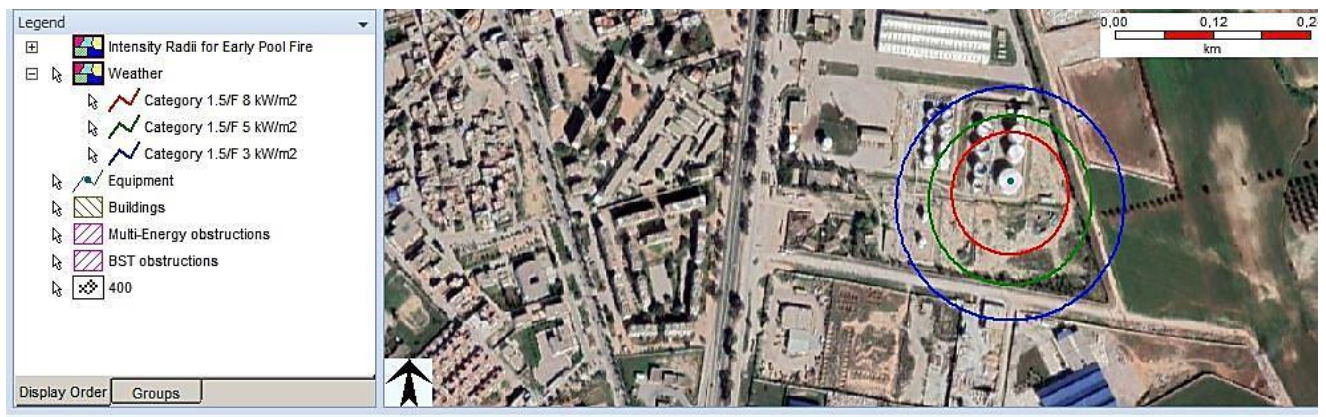
Figure IV.5: Contours d’effets du risque feu nappe.
