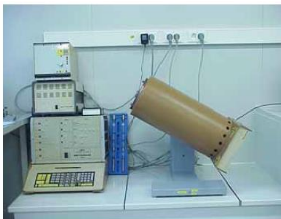
Figure V.4 : Calorimètre C80 SETARAM : Utilisation de la cellule détournement (LSPC, INERIS 2005)
