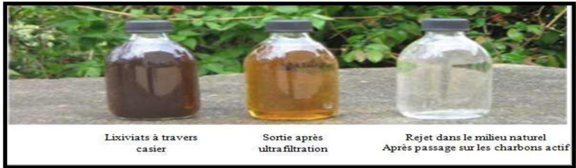
Fig. 5 : traitement du lixiviat.
