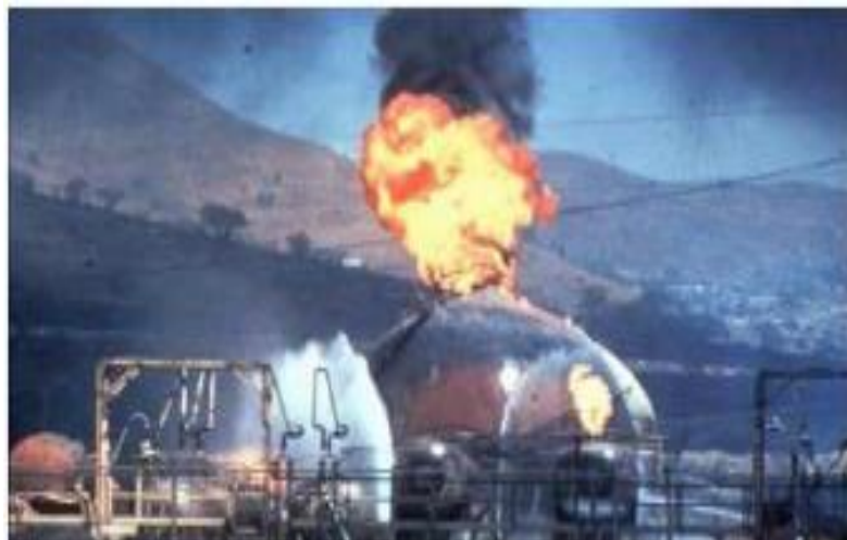
Figure I.1 : BLEVE d'un réservoir de GPL.
