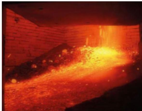
**Fig. II.20 : Refroidisseur du clinker à l'intérieur** <sup>[24]</sup>
