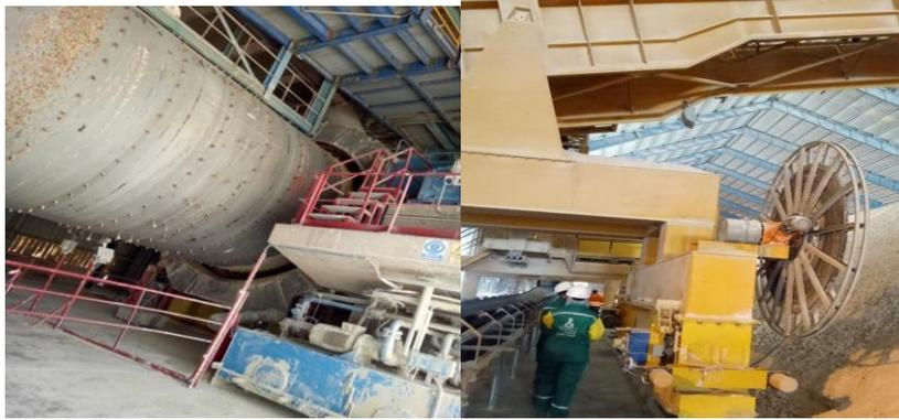
**Fig.I.14 : Broyeur et Atelier de broyage de LCO.**
