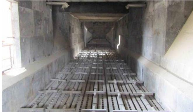
**Fig. II.21 : Grilles du refroidisseur** <sup>[25]</sup>
