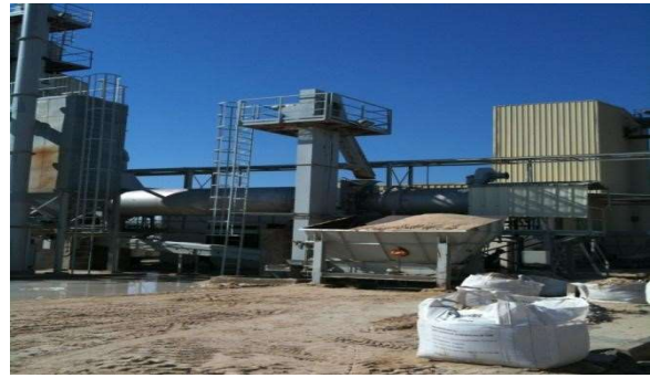
Figure IV.5 Lavage et séchage du sable
