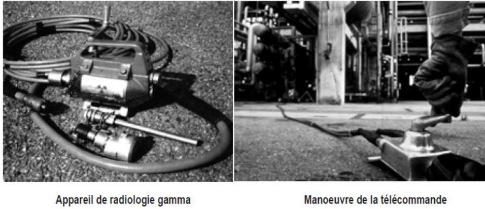
***Figure VIII.9 : Appareil radiologique gamma***
