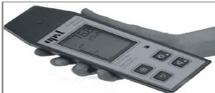
*Figure. III.17 : Compteur proportionnel FH40 (photo APVL Ingénierie)*
