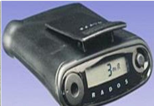
*Figure VII.17: Dosimètre électronique*
