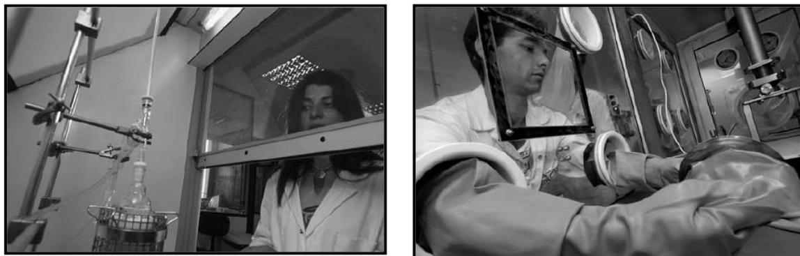
**Figure VII.9 : Illustration d'une hotte et d'une boîte à gants**
