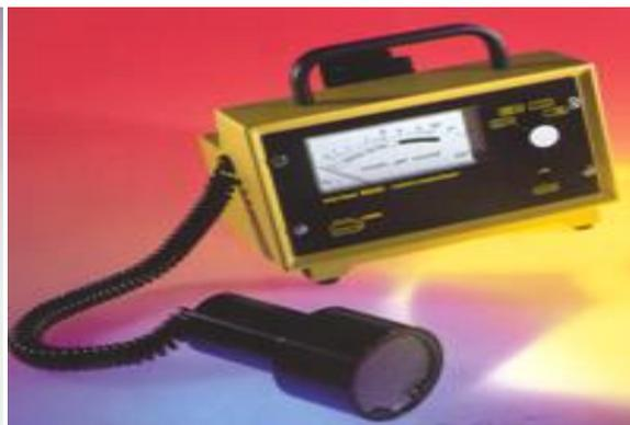
Figure VII.19 : Mesure de contamination
