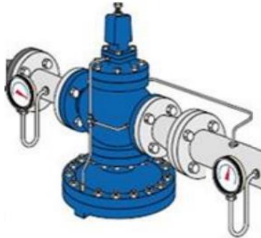
Figure II-7 : DÉTENDEUR RÉGULATEUR (élément du poste de détente)
