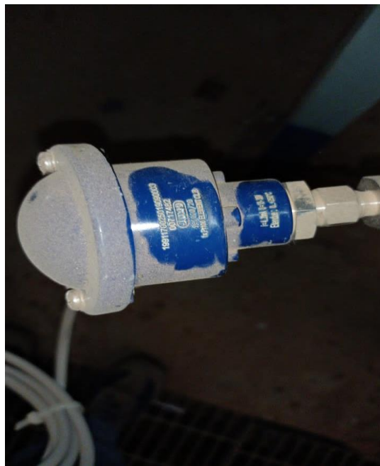
Figure II-13 : Transmetteur de température Sondes à résistance à visser Avec tête de raccordement, forme B
