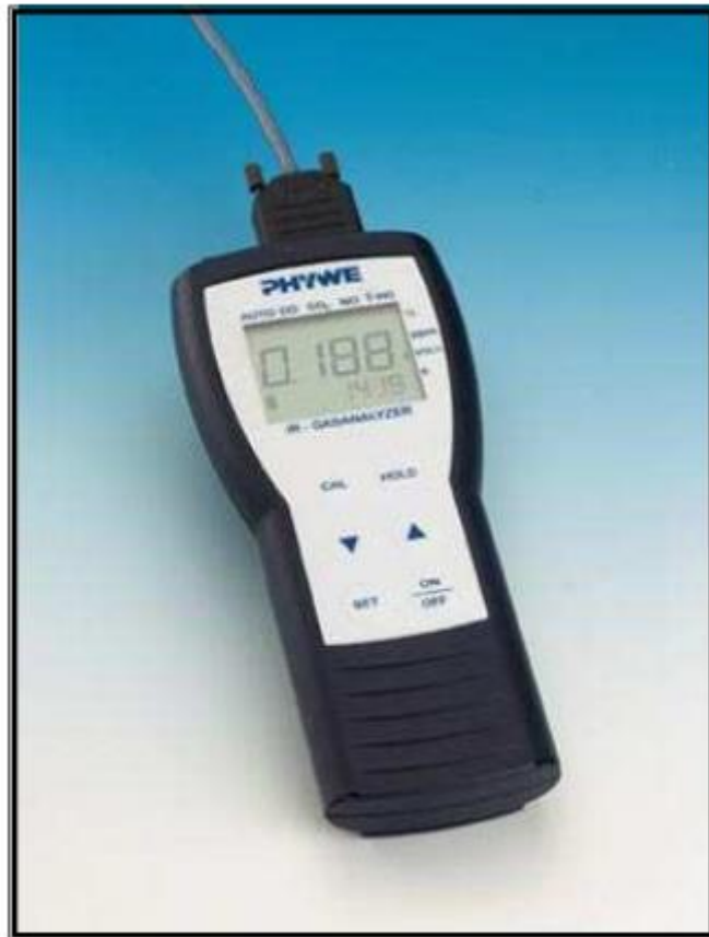
Figure16:Analyseur de gaz PHYWE
