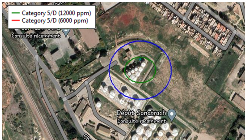
Figure 25 La zone atteint par le feu de flash
