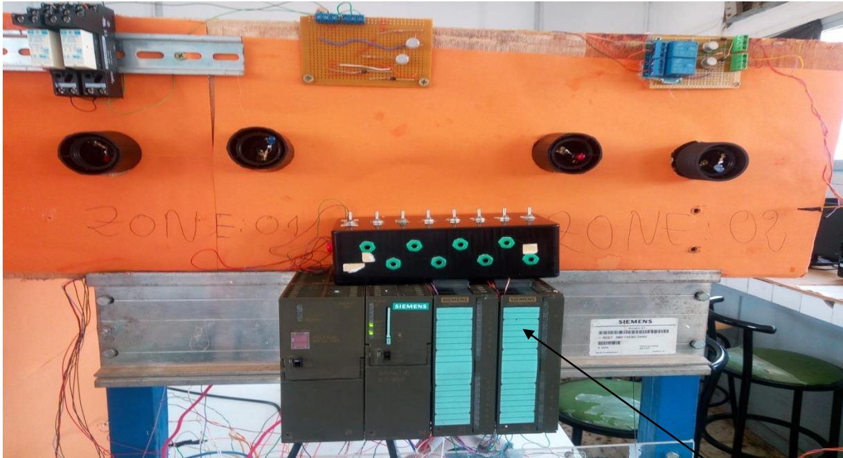
Figure III.28 : Automate S7-300 en absence de détection
