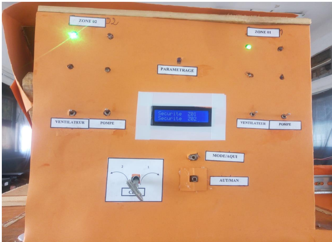
Figure III.25 : Interface de la centrale hors mode paramétrage
